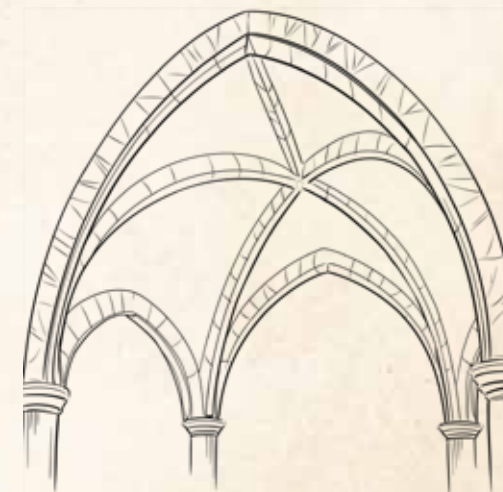
Voûte d'ogive à arcs brisés
